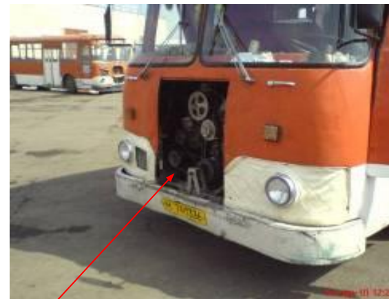
Наружный смотровой люк двигателя автобуса
