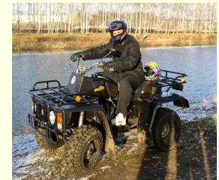
Квадроцикл "РЫСЬ" 2-х цилиндровый, 2-х тактный карбюраторный двигатель с водяным охлаждением.
