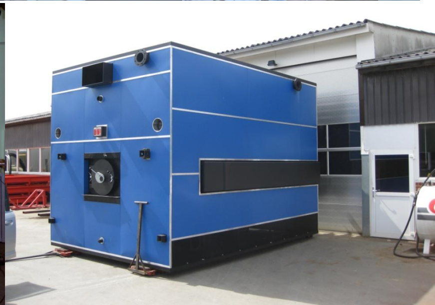
Котел в сборе готовый к установки в модульную котельную
