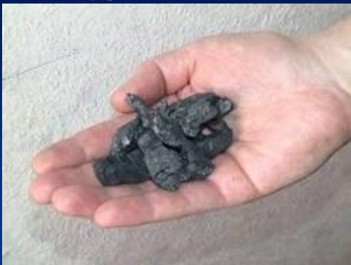
Среднетемпературный кокс из угля марки Д, Моховского разреза.
