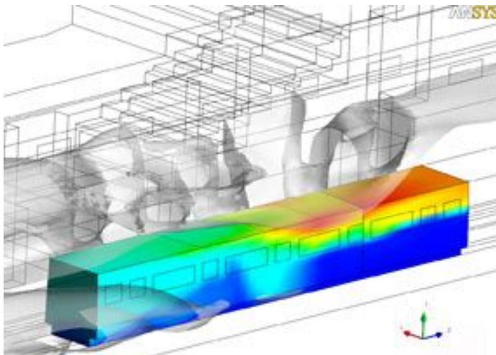
Изоповерхность концентрации углерода в момент времени  $t = 120$  сек (CFX-Post)
