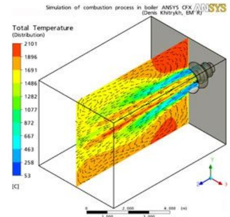
Общая структура течения в топочной камере и распределение температуры в топке 120 МВт котла
