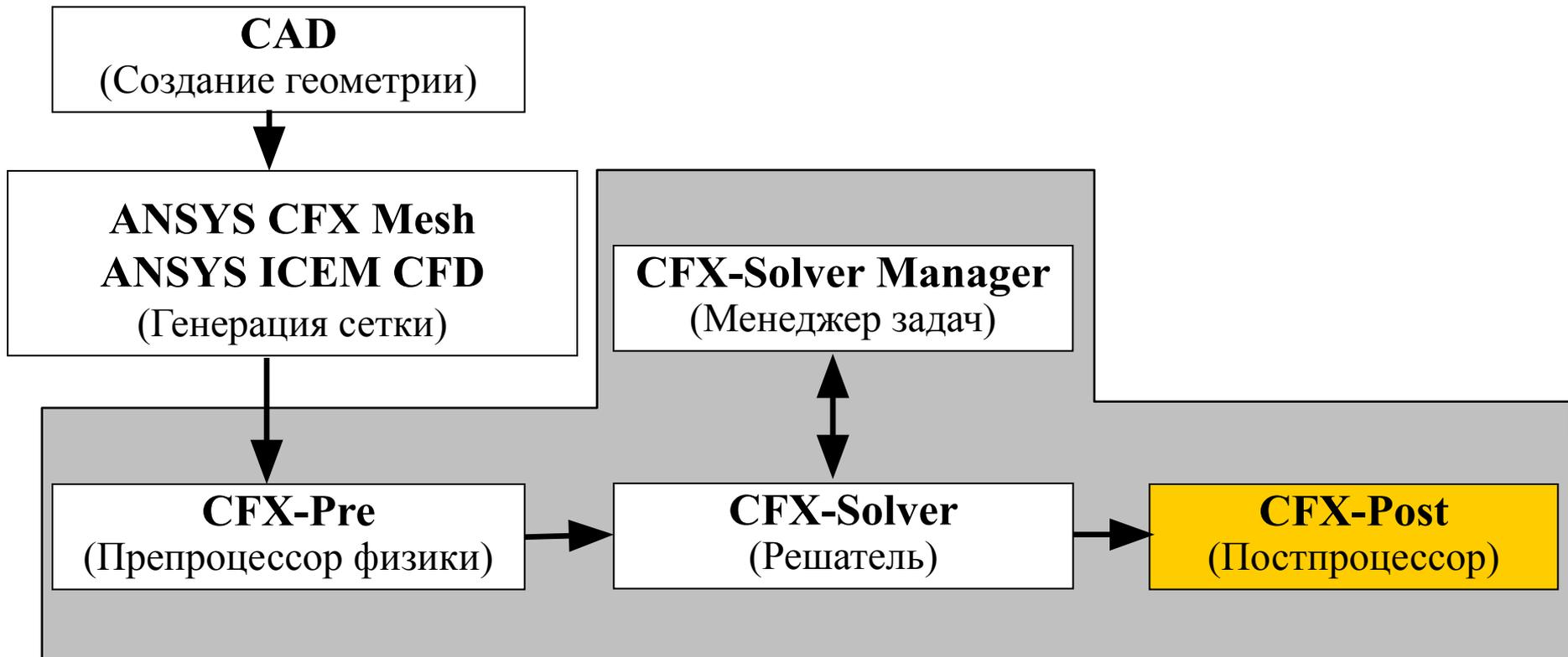
Постпроцессор **ANSYS CFX-Post** предназначен для анализа, визуализации и представления результатов, полученных в ходе решения задачи посредством ANSYS CFX-Solver. Для этого используются следующие средства:
