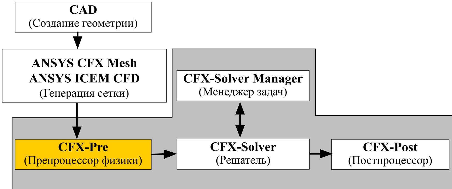
Физический препроцессор **ANSYS CFX-Pre** импортирует сетку, созданную генераторами сеток:
