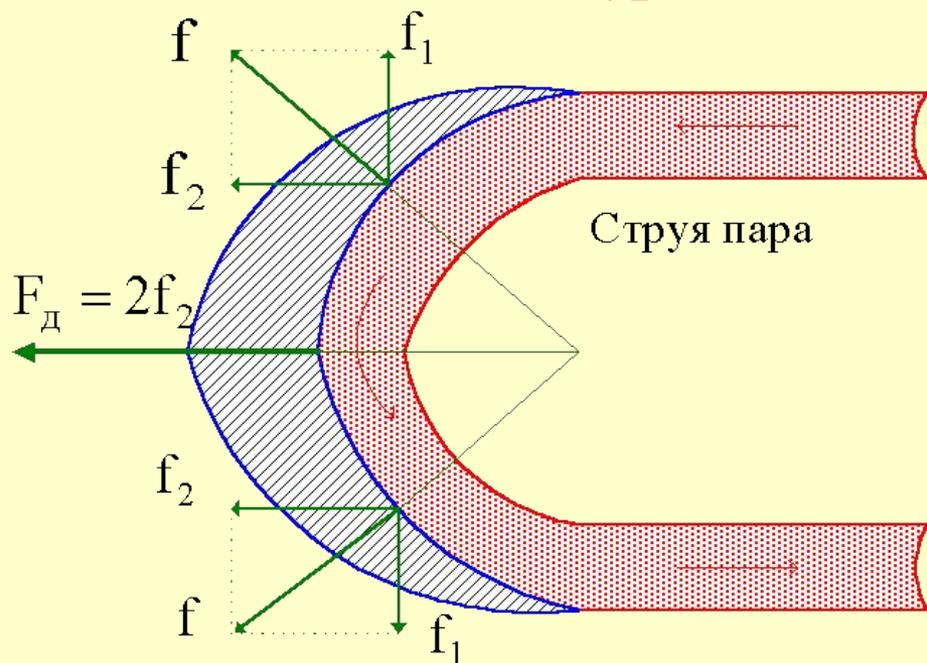
В активной турбине расширение пара между рабочими лопатками (синяя штриховка) не происходит и его давление не изменяется
