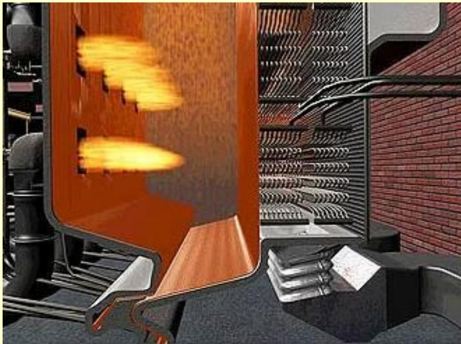
В зависимости от типа топлива в парогенераторах используются различные виды горелочных устройств: горелки для сжигания газа (на рисунке), мазутные форсунки, угольно-пылевые горелки.
