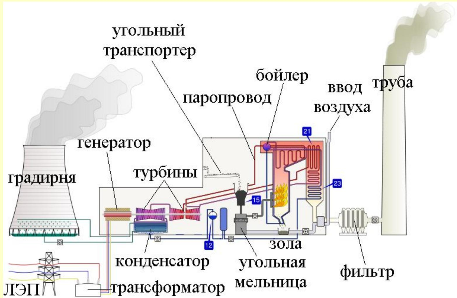
*Дополнительные обозначения: 12 – деаэратор, 15 – угледробилка, 21 – паронагреватель, 23 – экономайзер*
