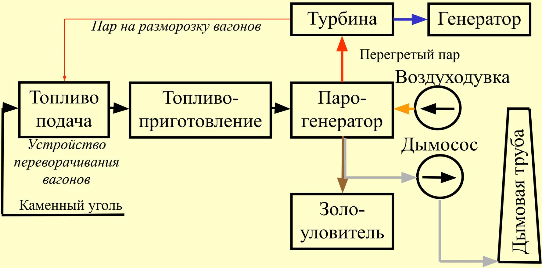
Топливоприготовление – дробление каменного угля в угольную пыль
