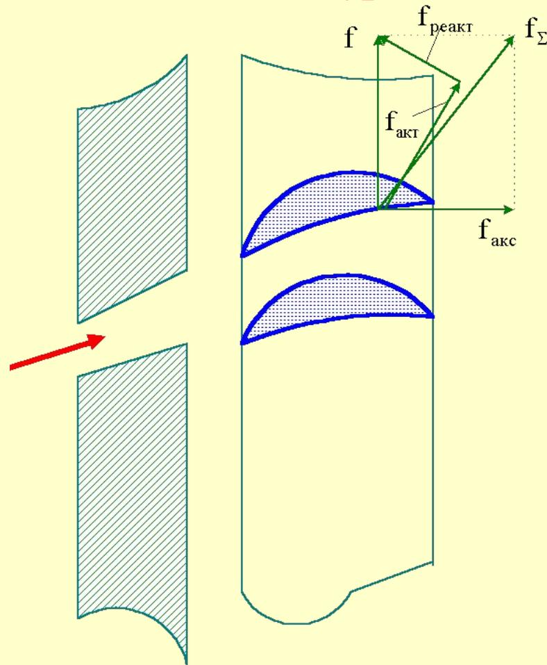
В реактивной турбине каналы между лопатками имеют сечения, подобные соплам. В результате расширения пара появляется реактивная сила
