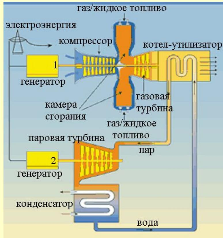
В газотурбинном цикле КПД не превышает  $38\%$ . В паросиловом цикле используется еще около  $20\%$  энергии сгоревшего топлива. В сумме КПД всей установки оказывается около  $58\%$ .
