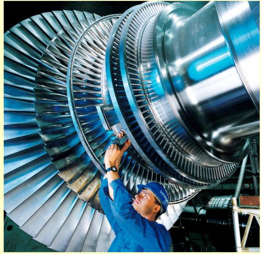
В соплах происходит увеличение скорости пара (300-400 м/с вдоль оси сопла) и снижение  $P$  и  $t$ .
