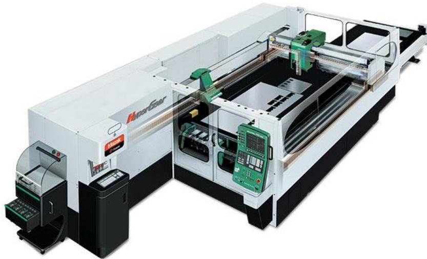
Станок лазерной резки металла
