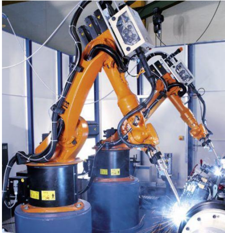
Роботы-манипуляторы Кука KR200 и сварочные роботы Кука KR16
