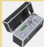
Анализ дымовых газов, измерение температуры и разряжения
