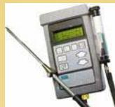
Анализ дымовых газов, измерение температуры и разряжения
