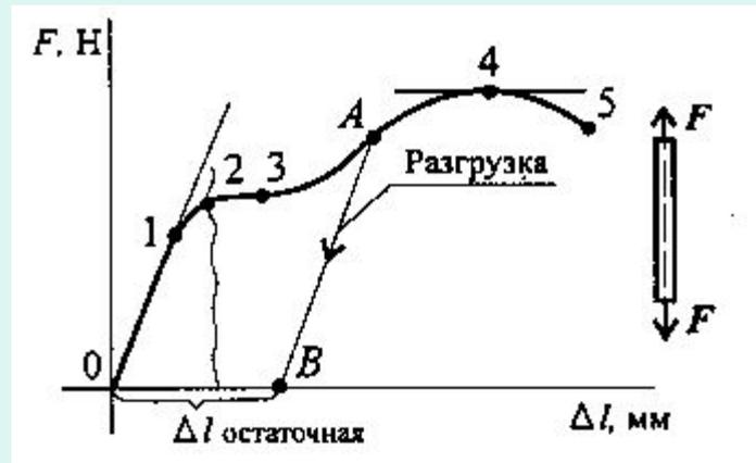
При продолжении испытания **после точки 2** образец уже не возвращается к исходным размерам, деформации начинают накапливаться. В **точке А** образец несколько сжимается по линии АВ, параллельной линии 01.
