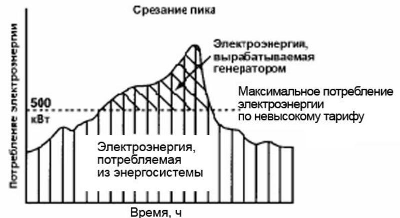
Пример графика нагрузки предприятия с использованием блок-станций в режиме срезания пика.
