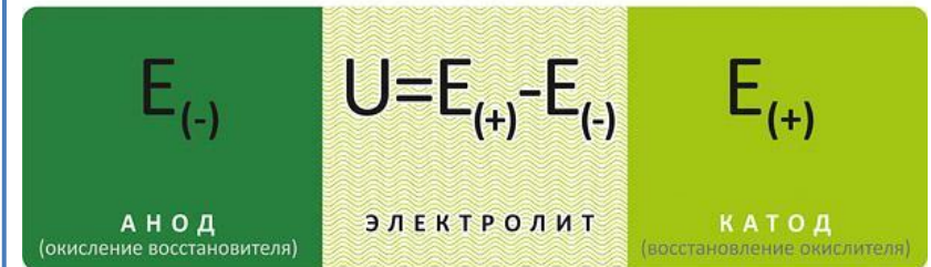
СХЕМА ГАЛЬВАНИЧЕСКОГО ЭЛЕМЕНТА
