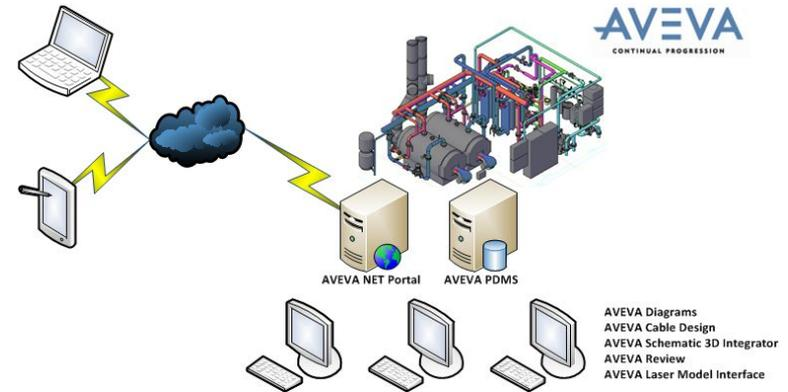
Основные функции системы трехмерного проектирования – (1) компоновка оборудования и строительных конструкций с использованием базы данных оборудования и материалов и (2) выпуск проектной и рабочей документации (чертежи и спецификации).
