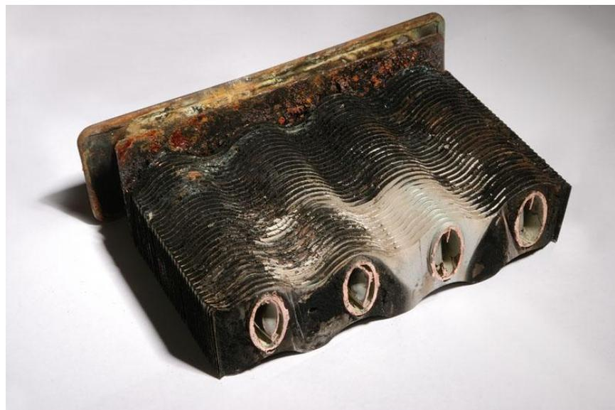
**ВОЗДЕЙСТВИЕ :** АГРЕССИВНАЯ КОРРОЗИЯ
