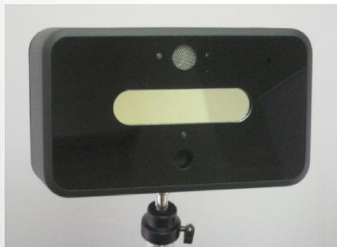
Специализированная камера высокого разрешения для работы в составе систем массовой биометрической идентификации. Данная модель оборудована сенсором ЗМП(СМОС), все получаемые изображения соответствуют международному стандарту ISO/IEC 19794-6, что гарантирует максимально точный процесс идентификации.
