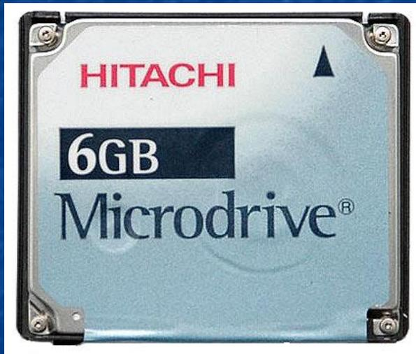
Компания IBM разработала новый носитель под стандарт Compact Flash на основе миниатюрного винчестера. В настоящее время существуют модели размером до 6 Гб.
