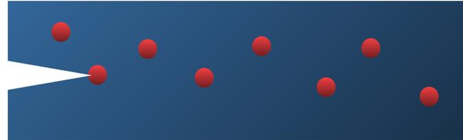
Упрочнение за счет системы двух фаз, изменяемые параметры:
