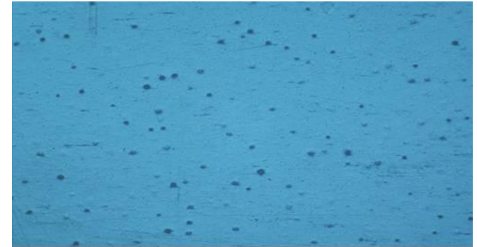
Пример пористого гелькоутного покрытия. На изображении под микроскопом видно, что воздух удален плохо
