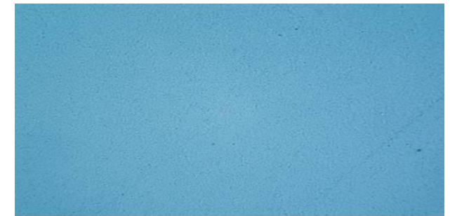
Пример гелевого покрытия, свободного от пор с использованием ненасыщенной полиэфирной смолы VIAPAL®. На изображении под микроскопом видно, что воздух удален хорошо
