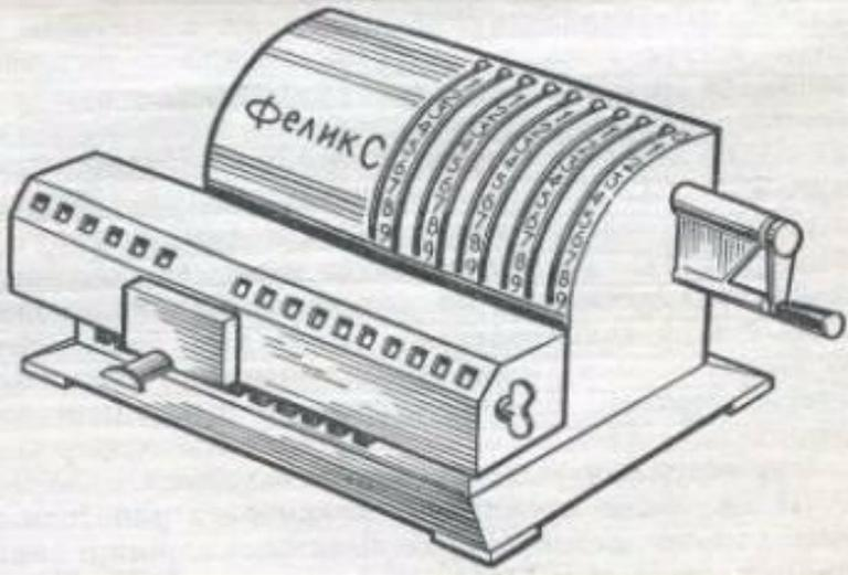
В 1880г. В.Т. Однер создает в России арифмометр с зубчаткой с переменным количеством зубцов, а в 1890 году налаживает массовый выпуск усовершенствованных арифмометров, которые в первой четверти 19-ого века были основными математическими машинами, нашедшими применение во всем мире. Их модернизация "Феликс" выпускалась в СССР до 50-х годов.
