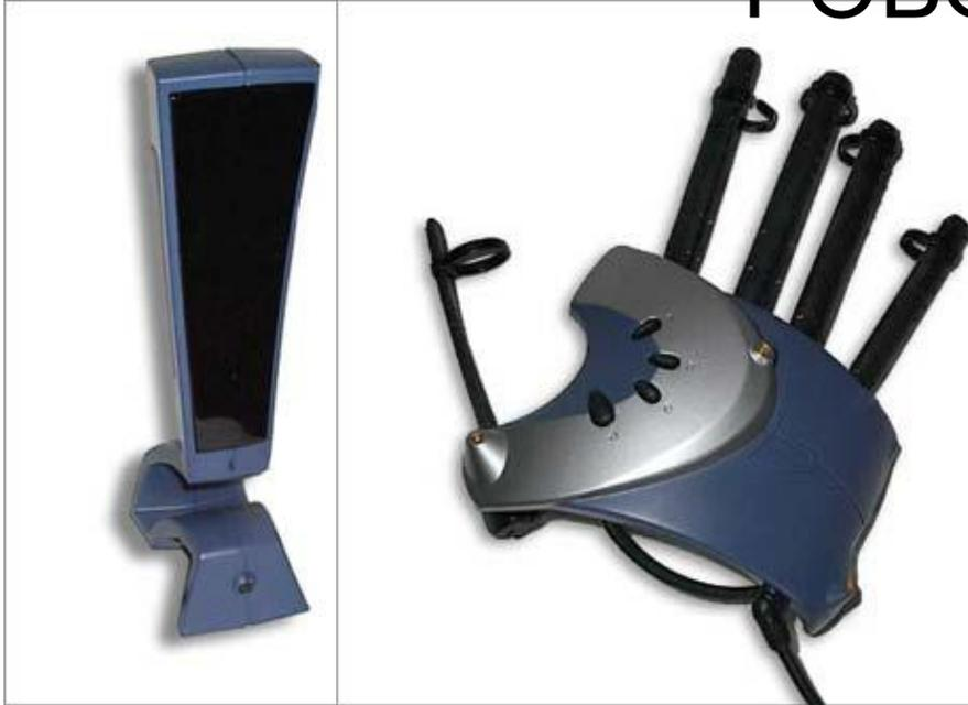
P5 состоит из двух частей - собственно перчатки (это, скорее, даже не перчатка, а накладка на руку) и базовой станции. Базовая станция включается в порт USB и не требует внешнего питания. Перчатка включается проводом в базовую станцию. На тыльной стороне "ладони" расположено 8 инфракрасных светодиодов (что характерно, цифровая камера их не "видит", хотя свет от обычного пульта ДУ она видит великолепно), которые позволяют базовой станции отслеживать перемещения руки в пространстве.
