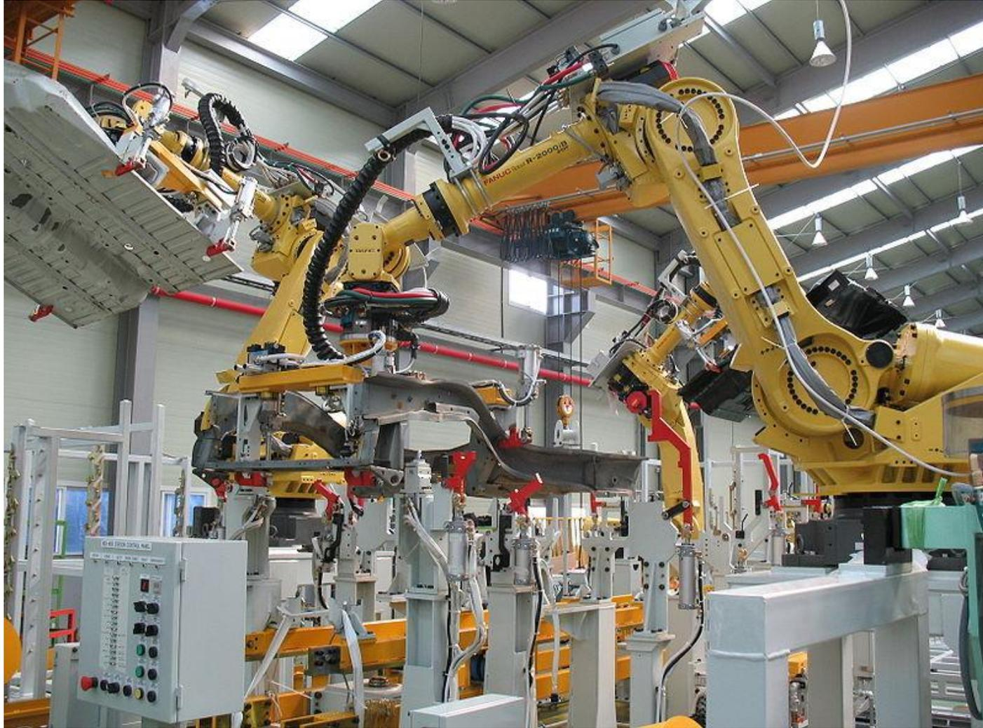
Работающие промышленные роботы Fanuc модели R2000iB
