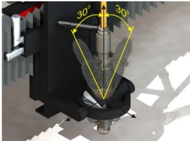
Машина оснащена системой поворота оптической головы на угол до 30 град, что позволяет производить фасонную резку.
