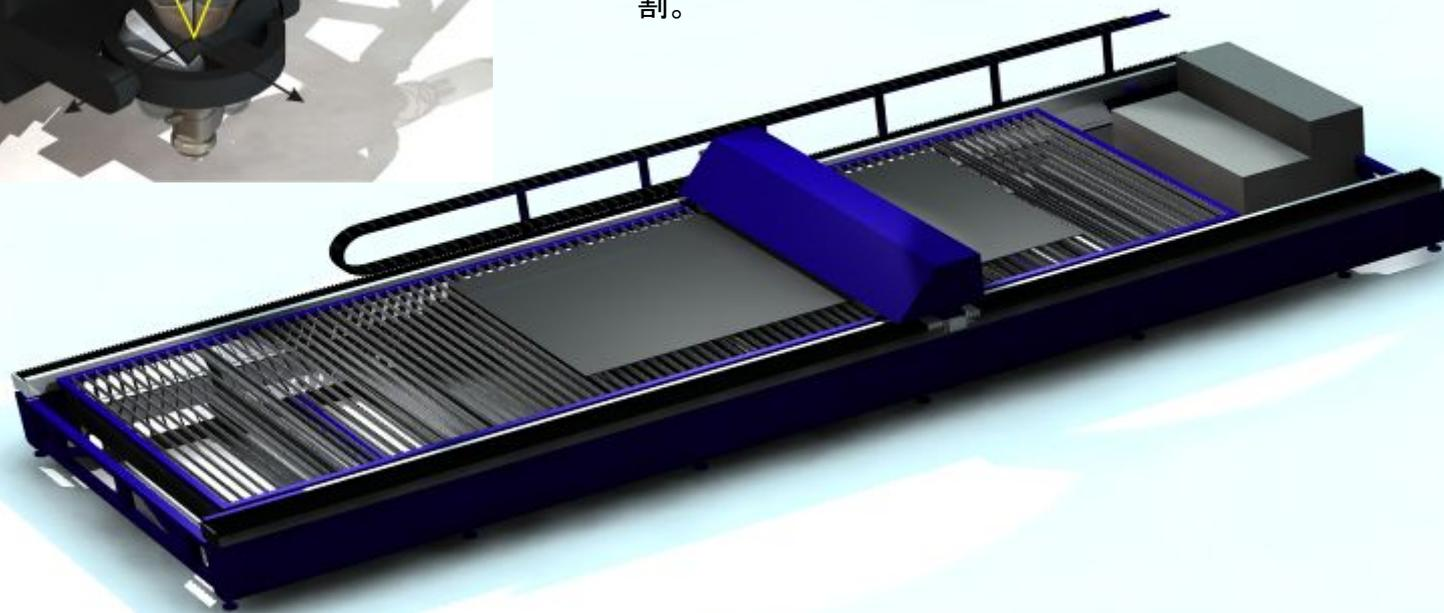
Координатная системы машины построена на приводах прямого действия, обеспечивающих скорость подачи по осям до 180 м/мин и повторяемость отработки траектории в пределах +/- 50 мкм.
