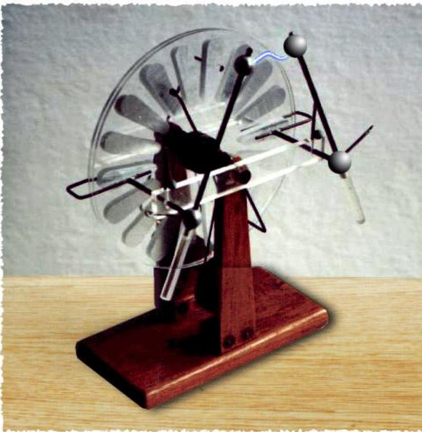
Основные части электрофорной машины – два вращающихся в противоположные стороны пластмассовых диска и две лейденские банки. Внешние обкладки банок соединяются между собой подвижной пластиной, расположенной между двумя зажимами, а внутренние соединены с отдельными кондукторами. За изолирующие ручки кондукторы можно поворачивать и изменять расстояние между ними. С внешней стороны на диски нанесены алюминиевые секторы, с которыми соприкасаются щетки, укрепленные в щеткодержателях.
