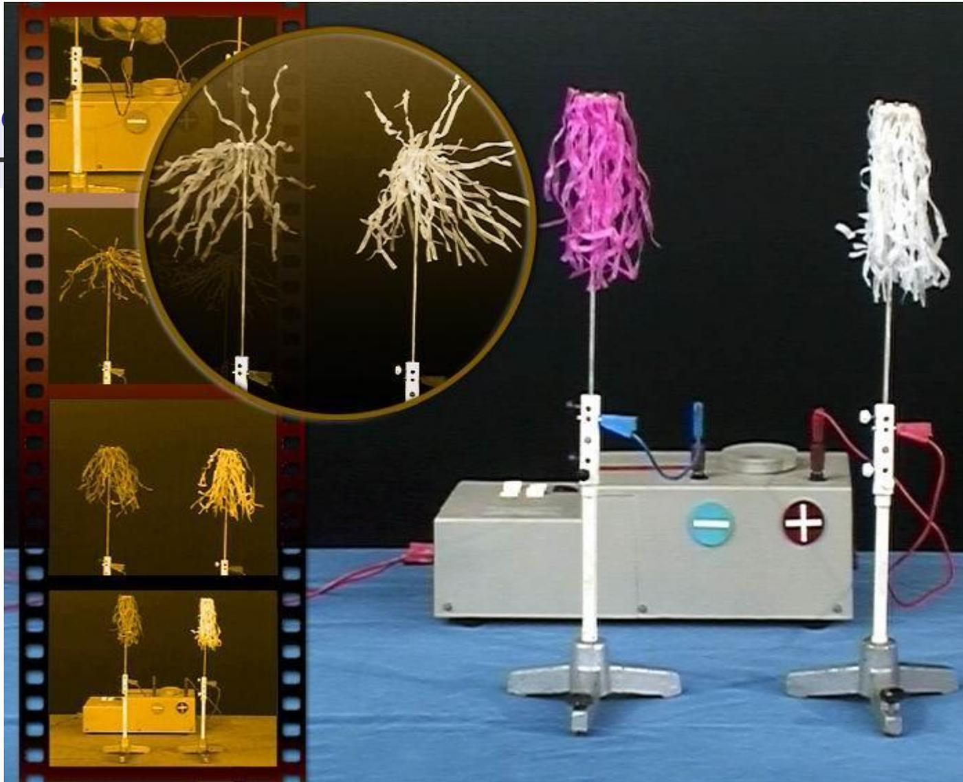
Машина электрофорная малая – демонстрационно-вспомогательный прибор; служит для получения больших зарядов.
