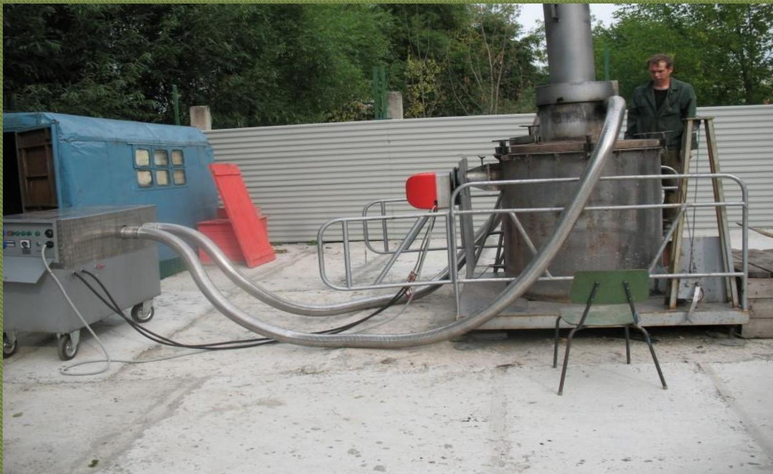
Установка утилизации (сжигания) отходов «Форсаж-2М»
