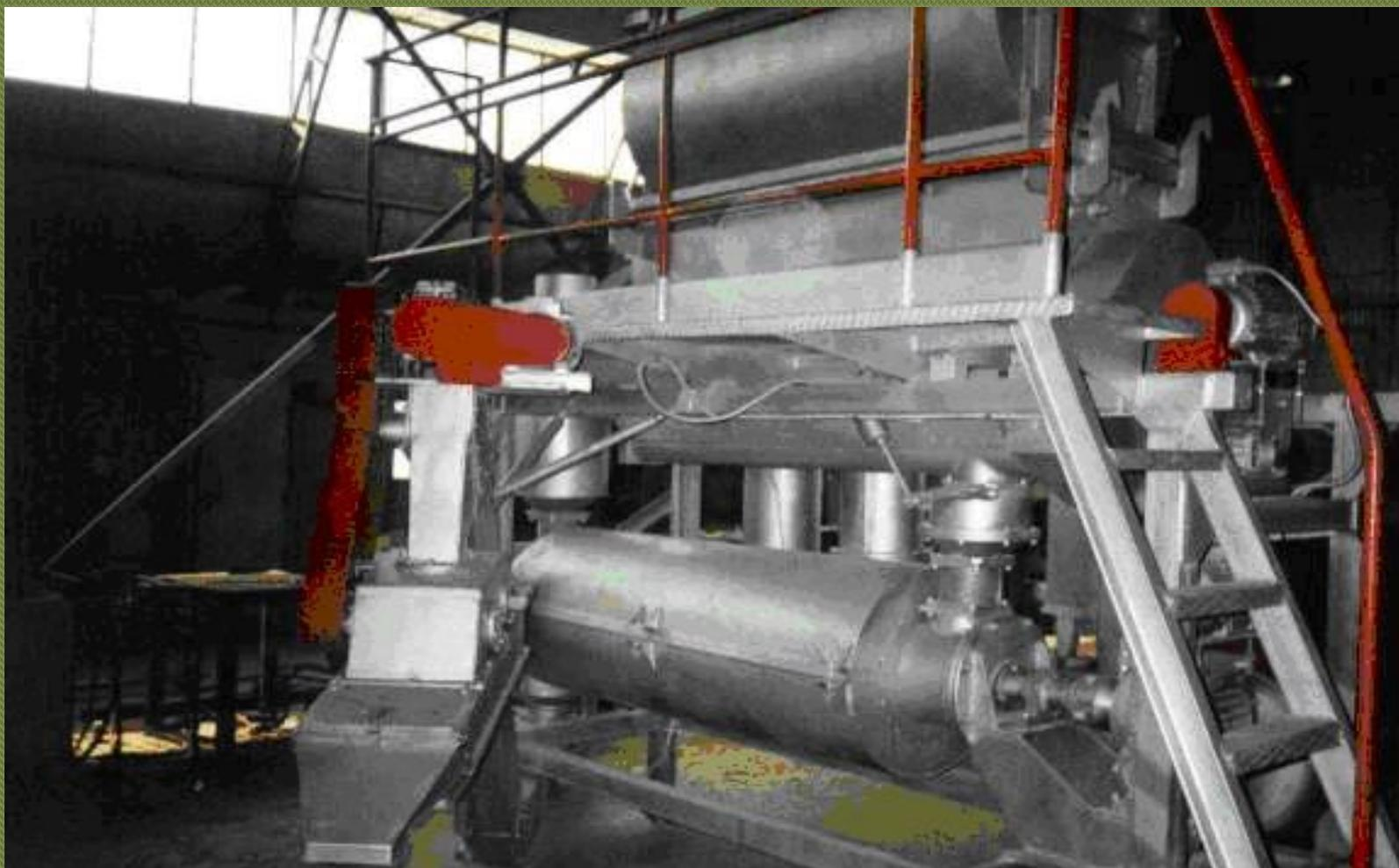
Установка для демеркуризации ртутьсодержащих ламп (модульная)
