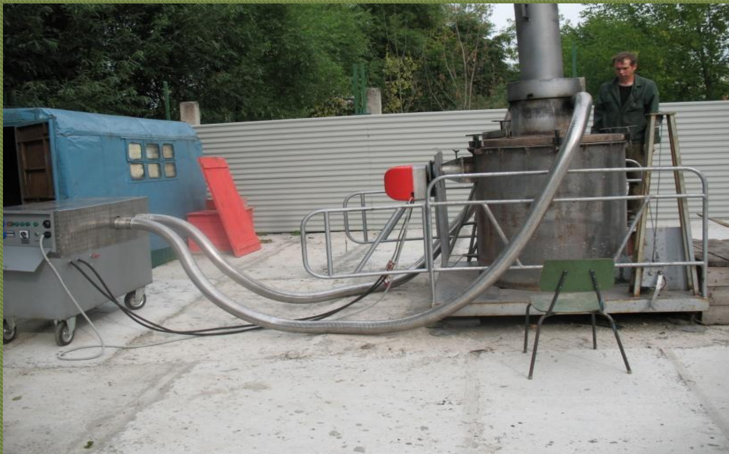
Установка утилизации (сжигания) отходов «Форсаж-2М» (ООО «УНР-17»)
