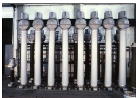
ТРАНСФОРМАТОР ТОКА 765 кВ ЭЛЕКТРОЗАВОД РОССИЯ
