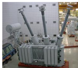
Генераторный трансформатор 160 МВА, 550 кВ, Мортлаке, АВСТРАЛИЯ
