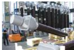
ИЗМЕРИТЕЛЬНЫЕ ТРАНСФОРМАТОРЫ 400 кВ ЭЛЕКТРОХОЗЯЙСТВО ГРЕЦИИ
