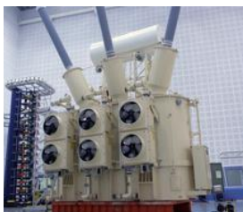
Генераторный трансформатор 140 МВА, Коматы, ЮАР
