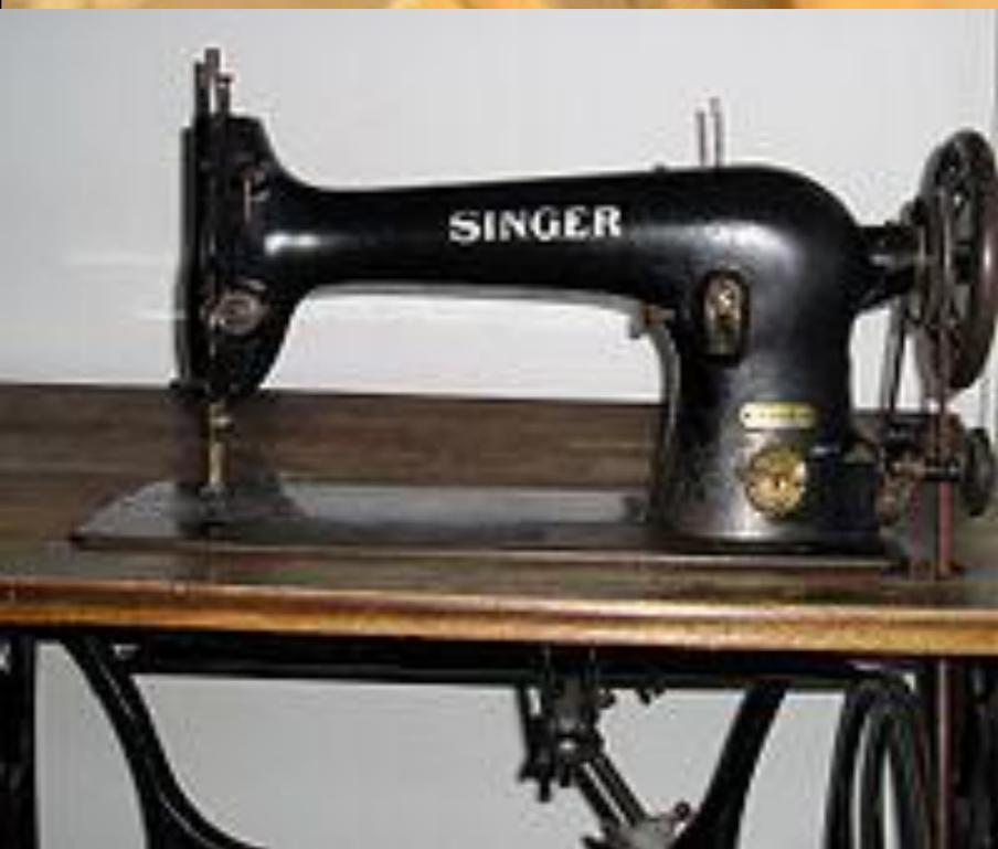
В 1850 году в швейном аппарате А. Вильсона, а позже в 1851 году и в машинах **Зингера и Гиббса** игла двигалась вертикально, а ткань, прижатая специальной лапкой, располагалась на горизонтальной платформе и её продвижение осуществлялось прерывисто движущимся зубчатым колесом, а впоследствии — зубчатой пластинкой (рейкой).
