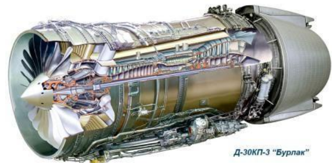
Д-30КП-3 "Бурлак" Двигатель с реверсом тяги
