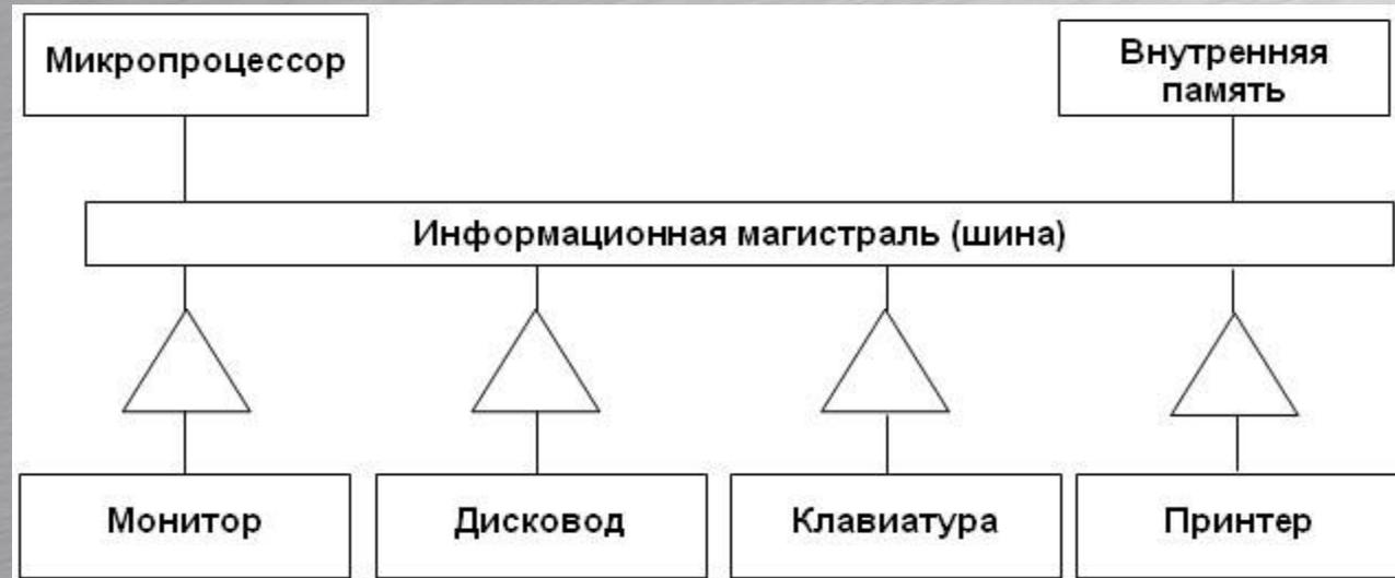
Структуру ПК, изображенную на рисунке, принято называть архитектурой с общей шиной (другое название — магистральная архитектура). Ее главное достоинство — простота, возможность легко изменять конфигурацию компьютера путем добавления новых или замены старых устройств. Отмеченные возможности принято называть принципом открытой архитектуры ПК.
