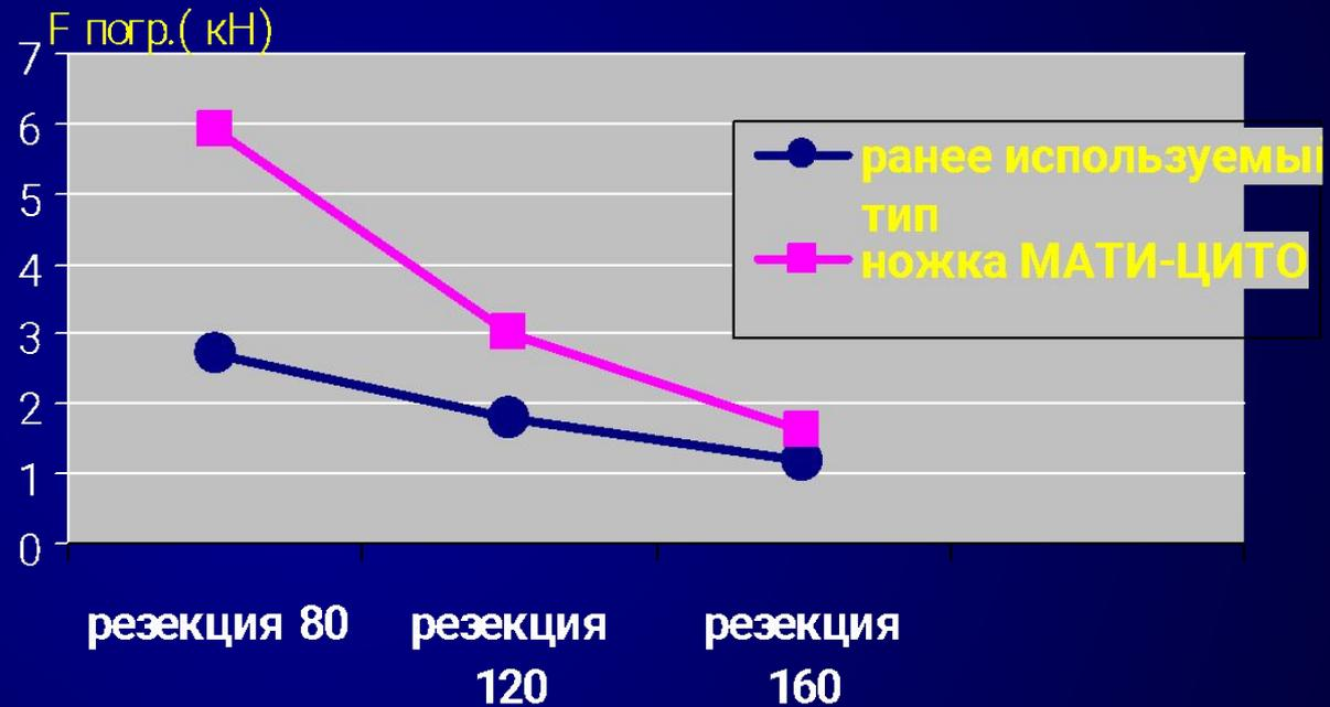
рис.3 Зависимость силы, необходимой для погружения имплантата в бедренную кость от уровня резекции.
