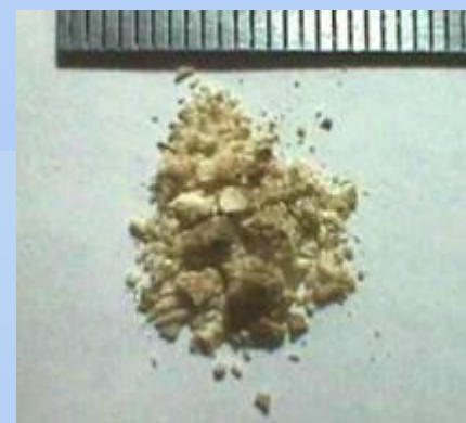
Фрагменты камня после экспериментального дробления (200 ударных импульсов)
