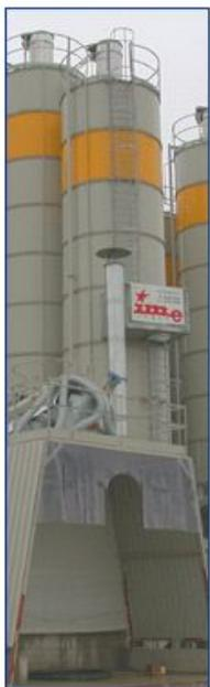
Фиксированные станции бетонирования, предназначенные для производства большого количества бетона. Снабженные двумя пунктами одновременной загрузки для бетономешалок. Идеальны для крупных строительных площадок, где необходимо большое количество бетона за короткий промежуток времени.
