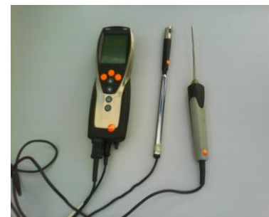
Универсальный измерительный комплекс Testo 430
