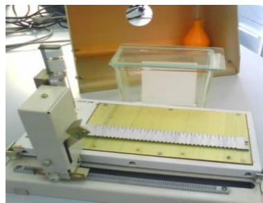
Тонкослойная хроматография (TLC).
