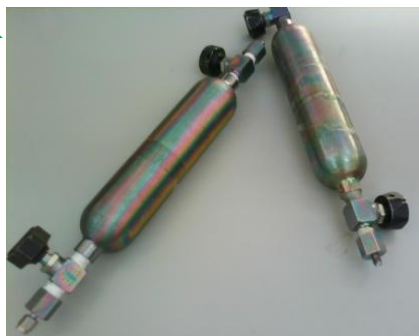
Пробоотборники с инертной внутренней поверхностью
