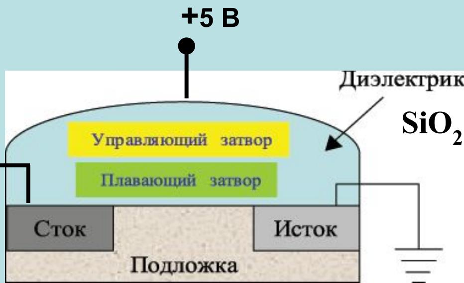
При записи данных на управляющий затвор подается положительное напряжение и электроны в результате эффекта туннелирования попадают на плавающий затвор. На нем они могут храниться в течение нескольких лет.
