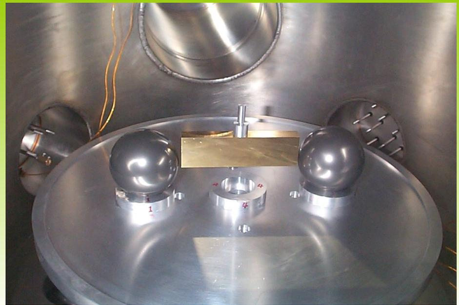
**Крутильные весы, притягивающие массы и поворотный стол внутри вакуумной камеры.**
