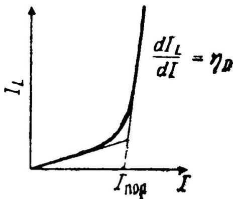
Зависимость интенсивности излучения от тока (к определению дифференциального квантового выхода).  $\eta_Q = (I_L/h\nu)/(I/e) = (e/h\nu)\eta_D$ .
