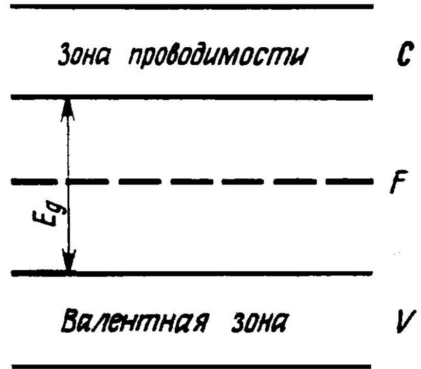
Валентная зона ( $V$ ), зона проводимости ( $C$ ) и уровень Ферми ( $F$ ) в полупроводнике.
