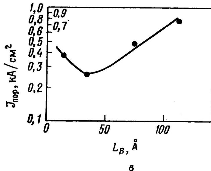
Модель лазера с модифицированной многослойной квантово-размерной структурой (а), зависимость плотности порогового тока от стехиометрического коэффициента  $x$  барьерного слоя (б) и толщины барьерного слоя в  $\text{Al}_{0,2}\text{Ga}_{0,8}\text{As}$  (в). (В эмиттерном слое  $y = 0,3-0,36$ )
