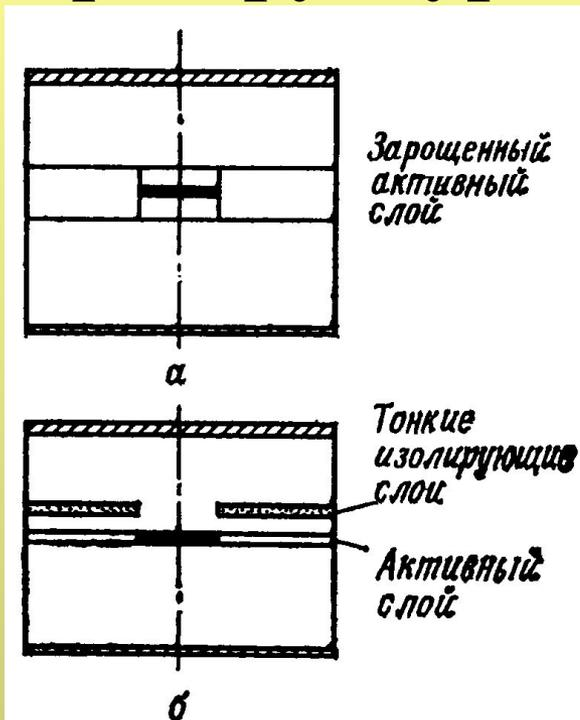
а — поперечное сечение полупроводникового лазера, удерживающего излучение в боковом направлении благодаря специальному профилю показателя преломления (встроенный волновод); б — лазер с волноводным эффектом в плоскости  $p-n$ -перехода, который обусловлен направляющим эффектом усиления.
