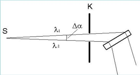
Ширина щели, формирующая пучок, определяет величину расходимости падающего на кристалл пучка. Для того, чтобы исследуемый кристалл отражал только одну длину волны  $\lambda_{K\alpha_1}$ , необходимо, чтобы угловая ширина падающего на кристалл пучка была меньше углового интервала между отражениями  $\lambda_{K\alpha_1}$  и  $\lambda_{K\alpha_2}$  (см.рисунок).
