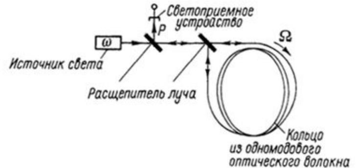
Если нелинейности значительны, то ВОГ будет обладать взаимностью лишь в том случае, если имеется точная симметрия свойств волокна относительно средней точки волоконного контура.
