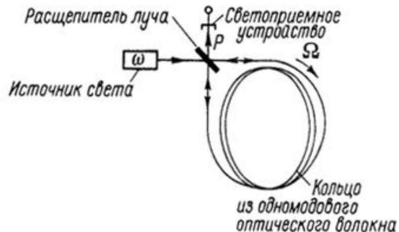
В отличие от КЛГ волоконно-оптические гироскопы позволяют измерять собственно угловую скорость, а не её приращение.
