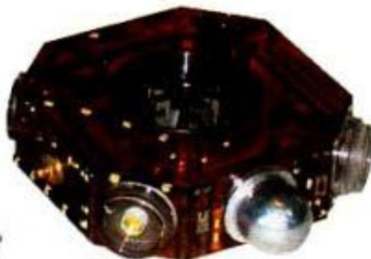
Лазерный гироскоп ЛГ-1 Серпуховского завода «Металлист». Три таких устройства, расположенных взаимно перпендикулярно, измеряют угловую скорость по трем осям с погрешностью примерно 0,1 оборота в сутки
