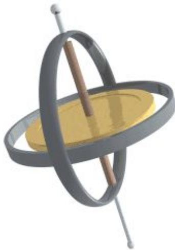
До недавнего времени в системах навигации в основном применялись механические гироскопы, работающие на основе эффекта удержания оси вращения тела в одном направлении инерциального пространства.
