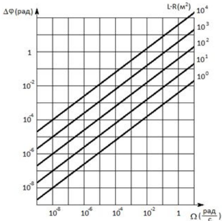
В типичных экспериментальных конструкциях гироскопов используется катушка с радиусом намотки  $R \approx 100$  мм при длине волокна  $L \approx 500$  м. Обнаружение скорости вращения в 1 град/ч требует регистрации фазы с разрешением порядка  $10^{-5}$  рад.
