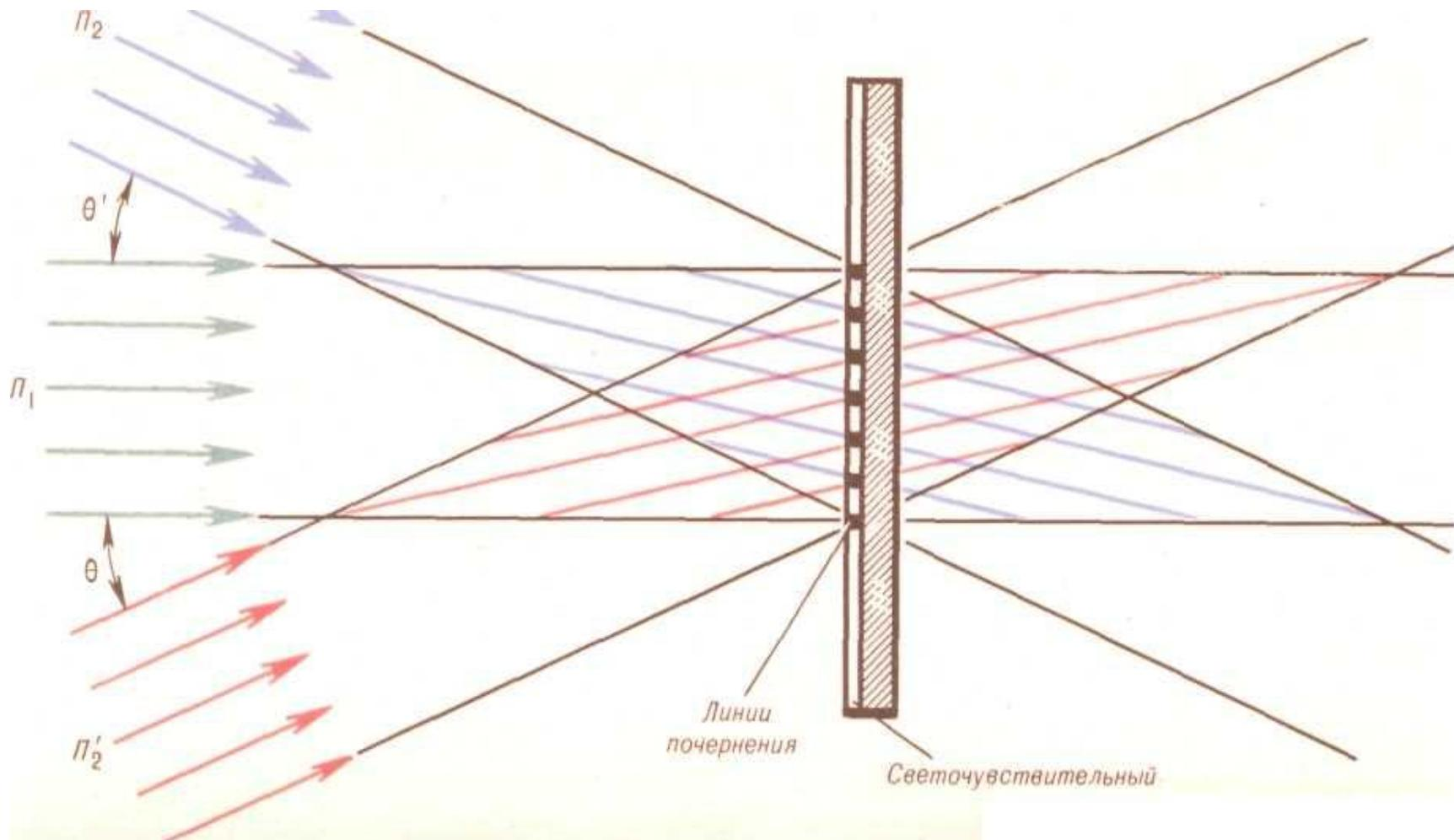
Возникновение вторичных дифракционных пучков света после прохождения параллельного пучка через плоскую голограмму с равномерным чередованием темных и светлых полос.
