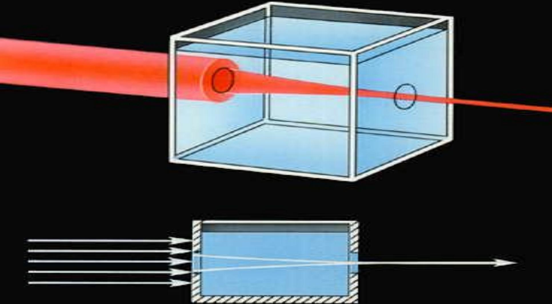
Удвоение частоты света. При прохождении красного света рубинового лазера (слева) с длиной волны  $\lambda = 6943 \text{ \AA}$  через кристалл KDP возникает невидимое ультрафиолетовое излучение с длиной волны  $\lambda_2 = \lambda/2 = 3472 \text{ \AA}$ .
