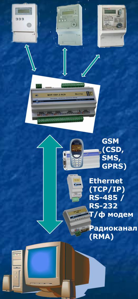
2. Адаптеры число-импульсных, частотных, и аналоговых сигналов серии MUR-1001.5 - микропроцессорные устройства, преобразующие поступающие от первичных приборов уровни сигналов в цифровой код.
