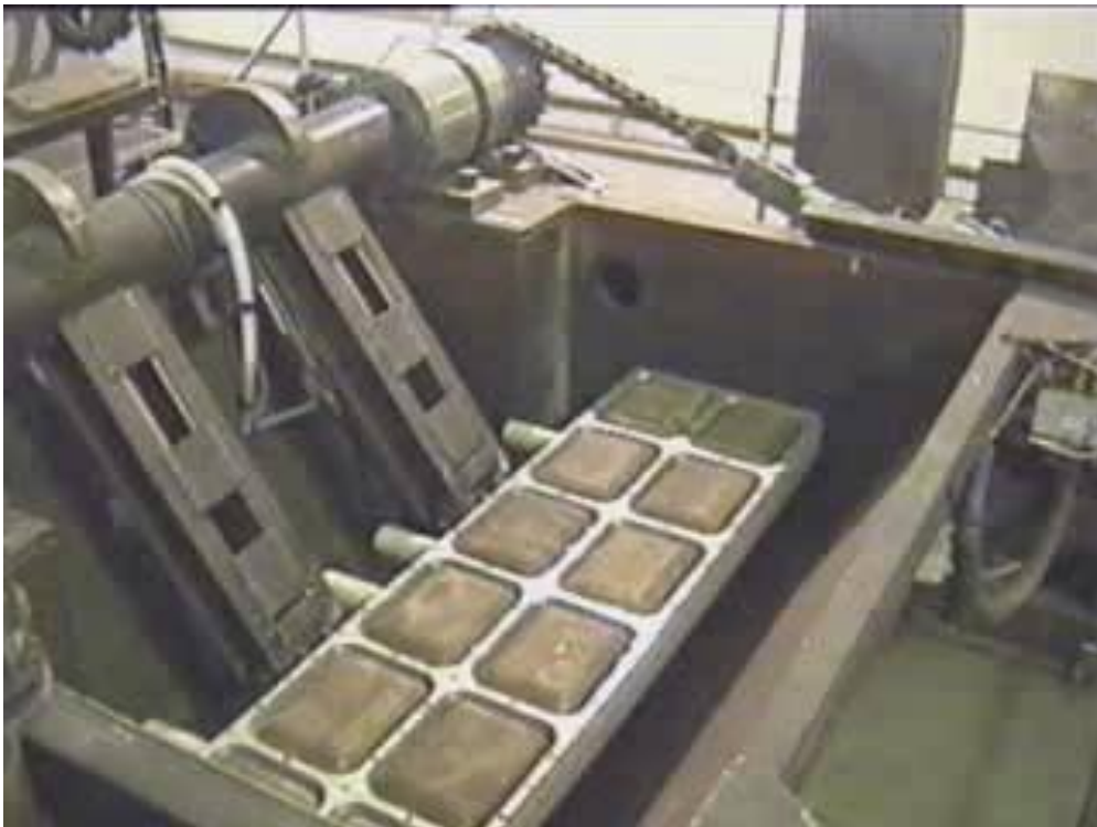
Формовочный станок СФ-6 для производства поддонов для расфасовки продуктов – «ООО Эко-Бридж» г. Москва
