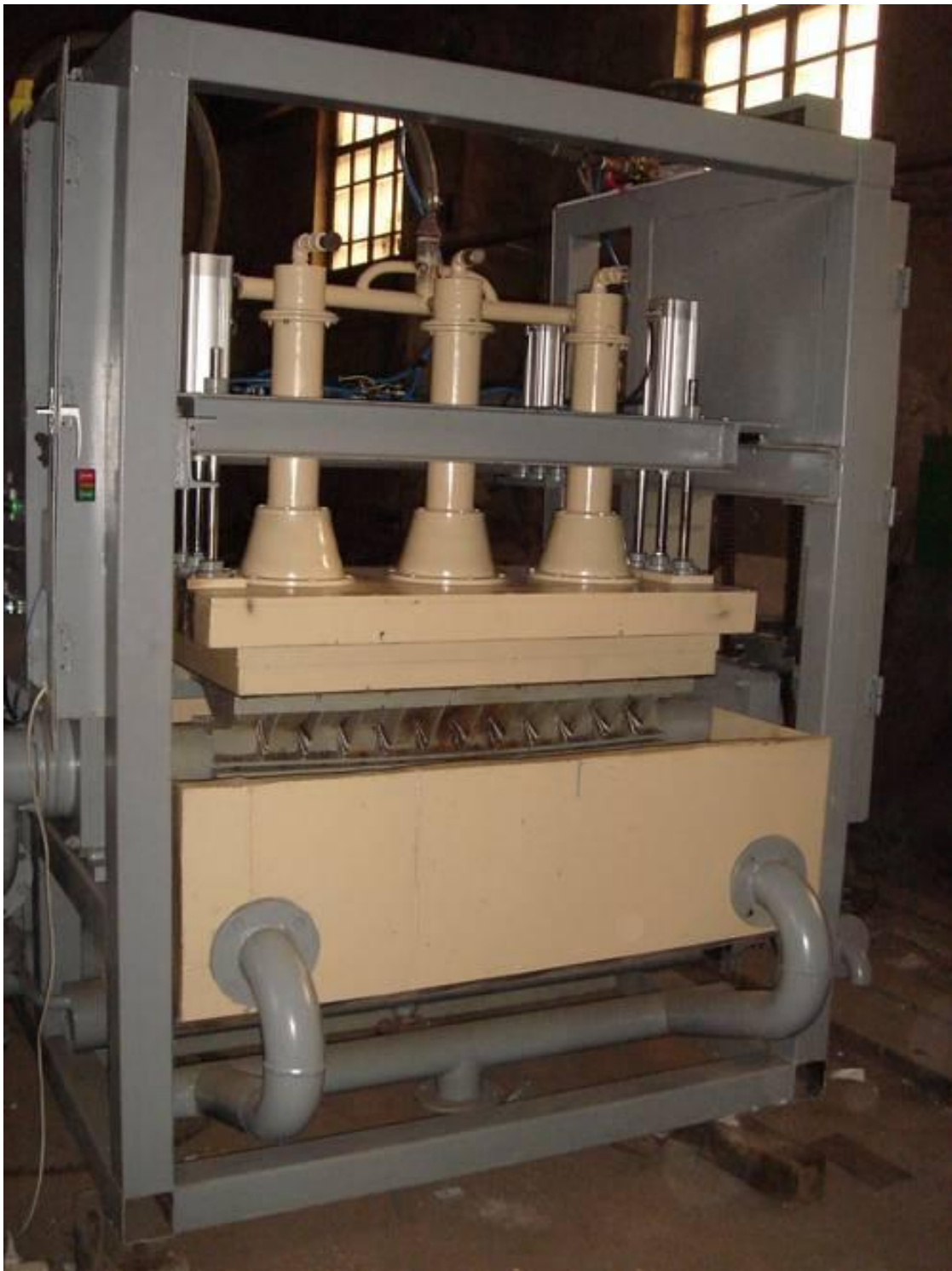
Автоматический формовочный станок СФ-4АС-3(без форм) для производства формованных объёмных изделий из макулатурной массы, изготовлен и испытан в марте 2011г., готов для работы в составе комплекса К-6АС-3,4 на новом предприятии данного проекта.
