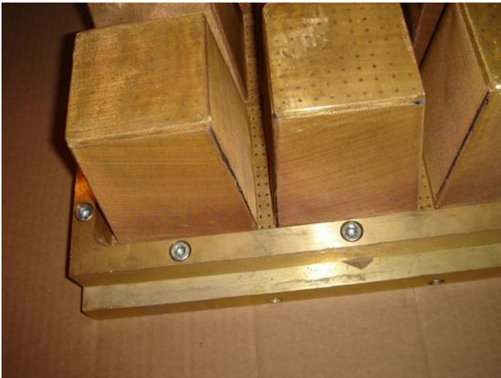
Сетчатые формы для производства горшочков для рассады «Агроблок №1», ООО «Лен Зауралья», г. Курган
