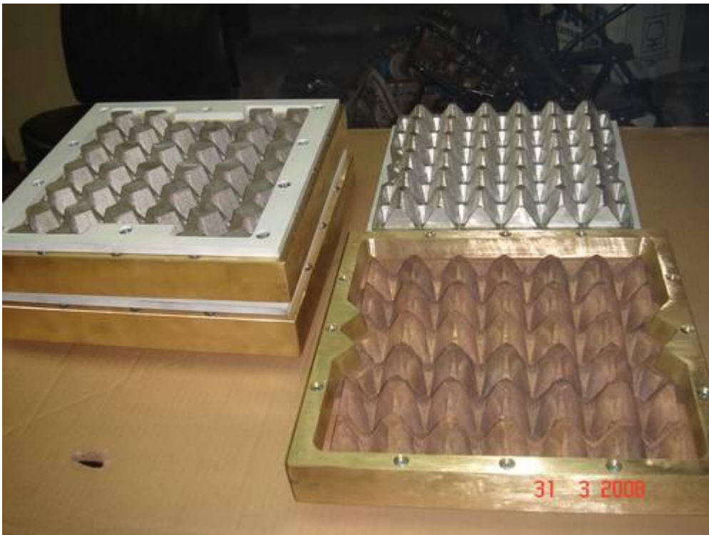
Сетчатые формы для производства бугорчатой прокладки для яиц №20 ОАО «Омская птицефабрика» г.Омск
