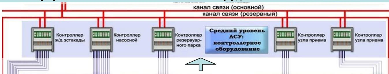
**Для связи с технологическими объектами управления в каждой подсистеме предусмотрены специализированные контроллеры. Контроллеры монтируются в шкафах автоматики управления и, как правило, размещаются в помещении операторной.**
