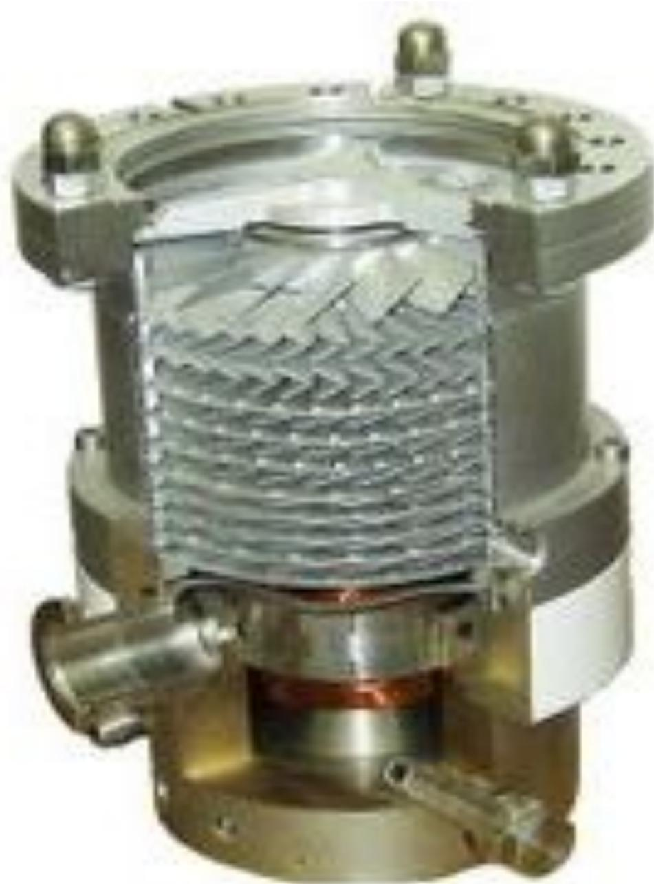
Вид современных турбомолекулярных насосов
