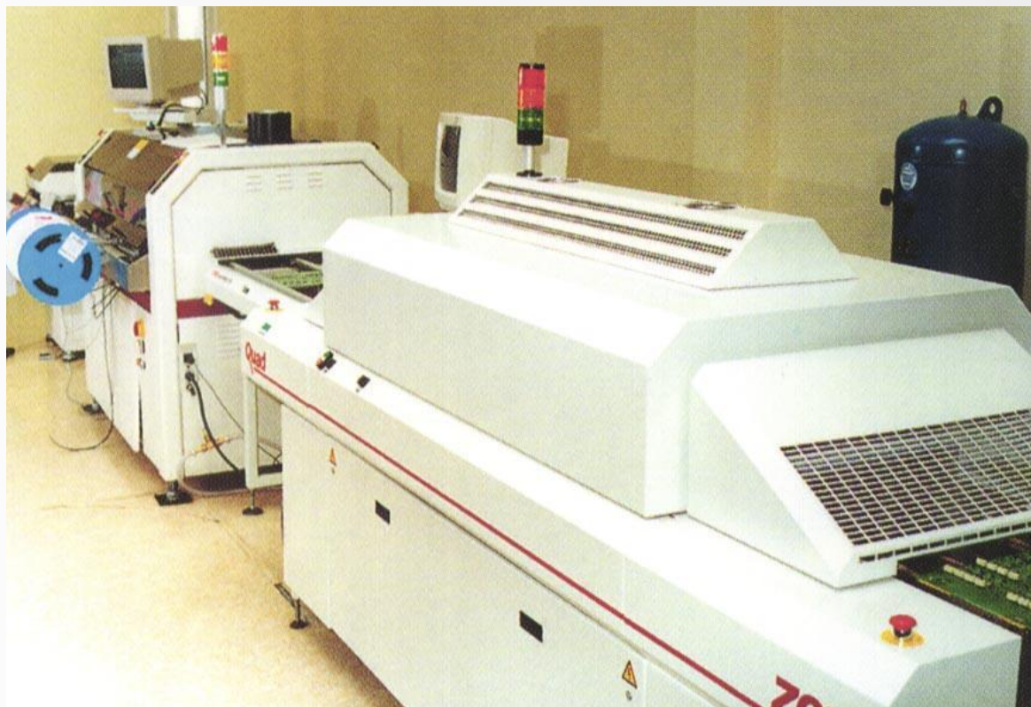
Линия автоматического монтажа плат для Ф-1500
