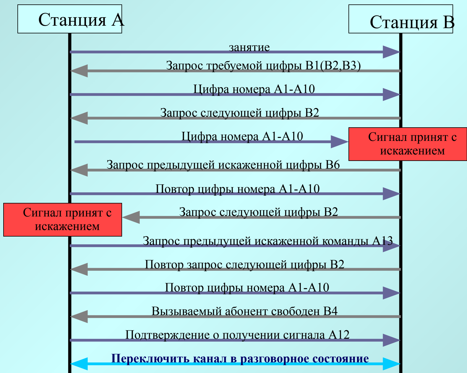
Пример обмена сигналами сигнализации R1.5
