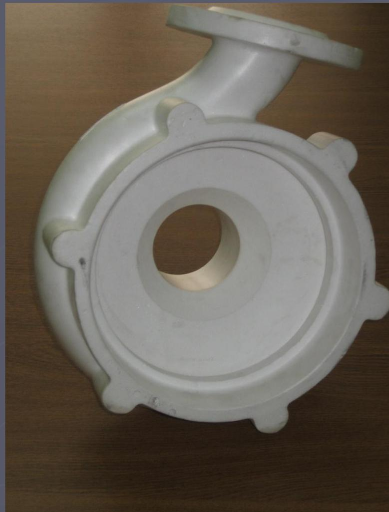
Проточная часть корпуса покрыта фортроном.
