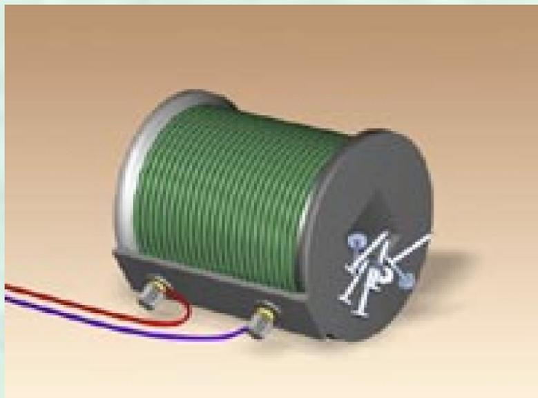
Катушка с железным сердечником внутри называется **электромагнитом**.
