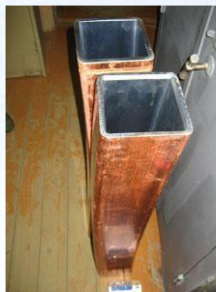
Кристаллизаторы – используются при производстве стального проката для формирования расплавленной стали
