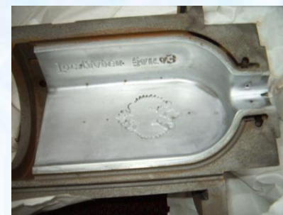
Чистовая чугунная форма – применяется в производстве стеклянных бутылок
