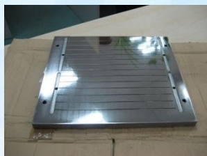
Калибратор – используется в линиях для экструзии изделий из ПВХ.
