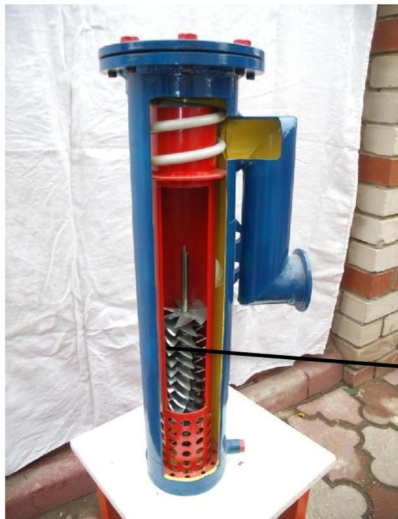
Рис.3. Сепаратор “ЕВК-6” в разрезе
