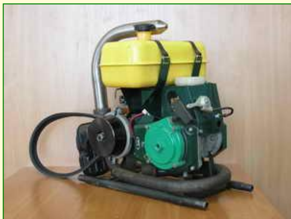
«Буян» с двигателем «ЭМ100» (100 см 3 )
