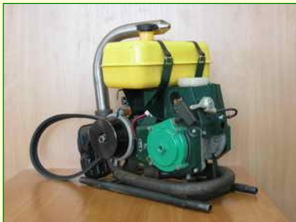
«Буян» с двигателем «ЭМ100» (100 см 3 )
