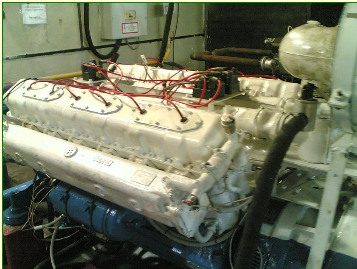
12 цилиндровый V-образный конвертированный газовый двигатель СКБ «Трансдизель» г.Челябинск «В-31-М2Г1»
