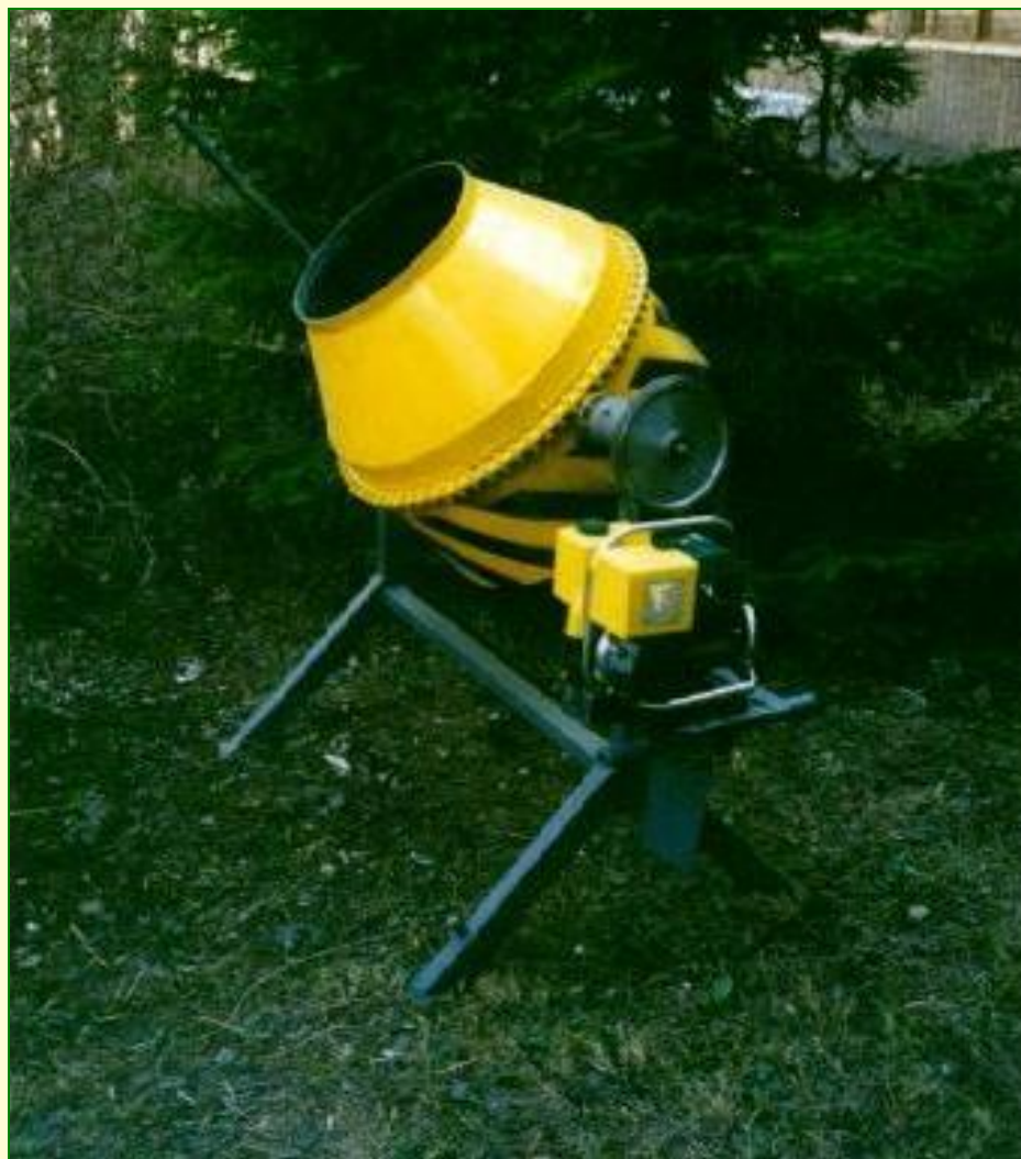
«Буян» с двигателем «ЭМ100» (100 см 3 )
