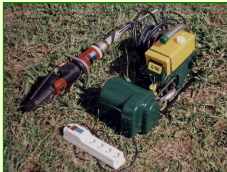
Буян-К – привод трех агрегатов
