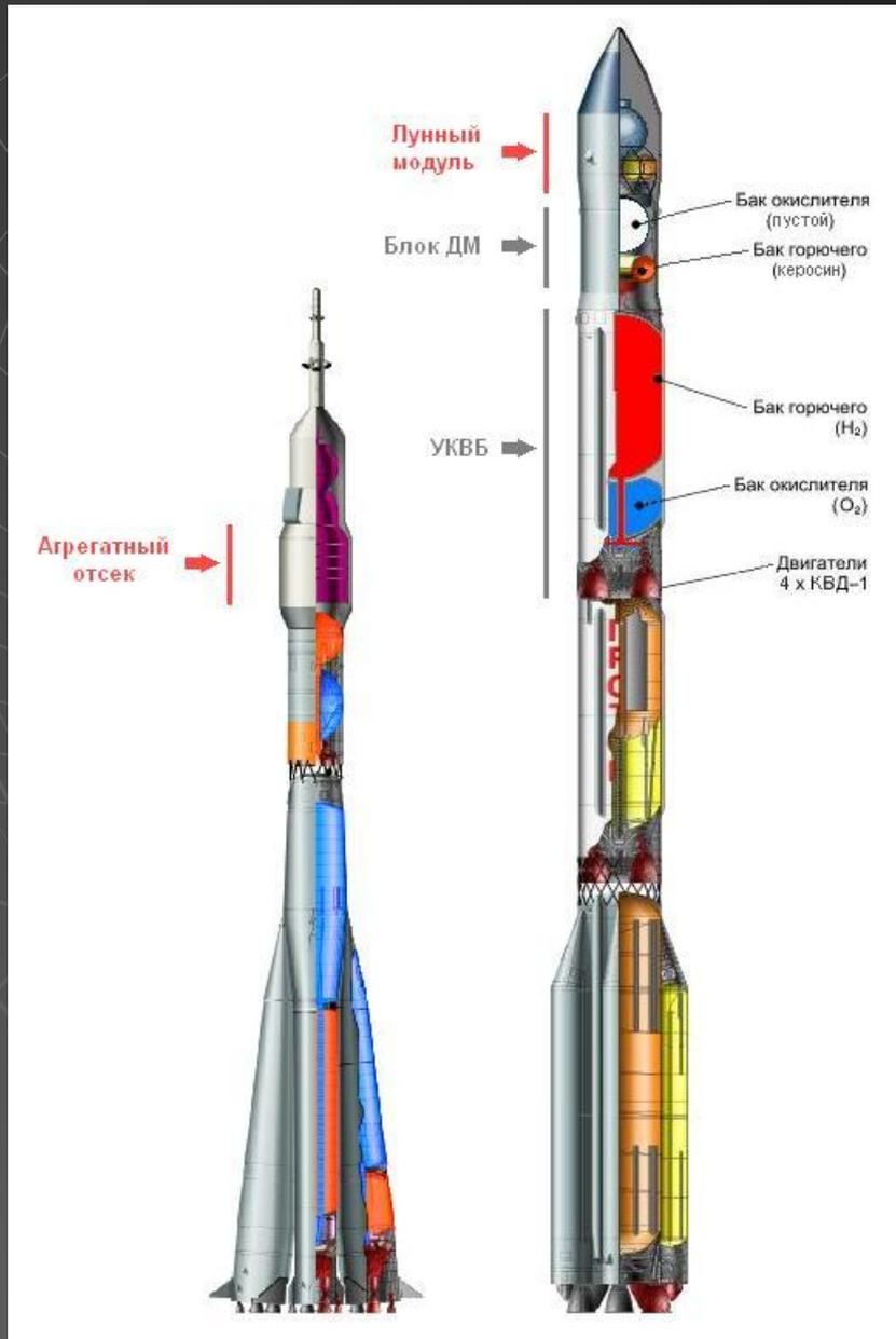
Заправка на орбите даёт возможность совершить полёт на Луну при использовании многоцелевых СВ обычной размерности. Двухпусковая схема с использованием модификаций носителей «Протон» и «Союз» обеспечивает параметры экспедиции, аналогичные достигнутым в программе «Аполлон». Доля исключительно «лунных» изделий в массе РН оказывается невелика, а расходы на экспедицию оцениваются в 350 миллионов долларов.
