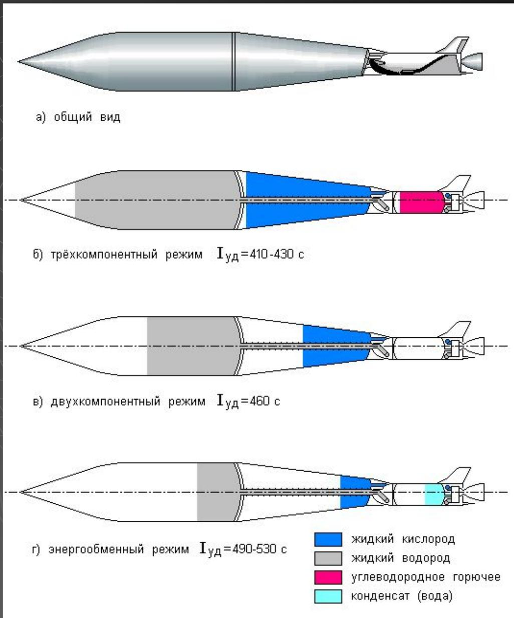
Трёхкомпонентная трёхрежимная двигательная установка, обеспечивающая последовательное увеличение удельного импульса тяги при переходе к каждому новому режиму работы, позволяет добиться аномально высокой грузоподъёмности
