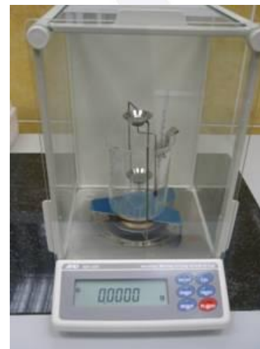
Для определения открытой пористости по ГОСТ 26450 используются аналитические весы с комплектом для гидростатического взвешивания
