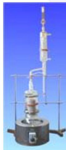
Для измерения водо- и нефтенасыщенности используется аппарат Дина-Старка
