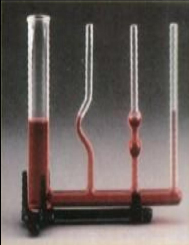
Если ёмкость с водой находится выше отверстия, присоединённого к нему шланга или трубы, то вода из отверстия будет бить вверх. И тем сильнее, чем больше разность уровней воды в ёмкости и отверстия.
