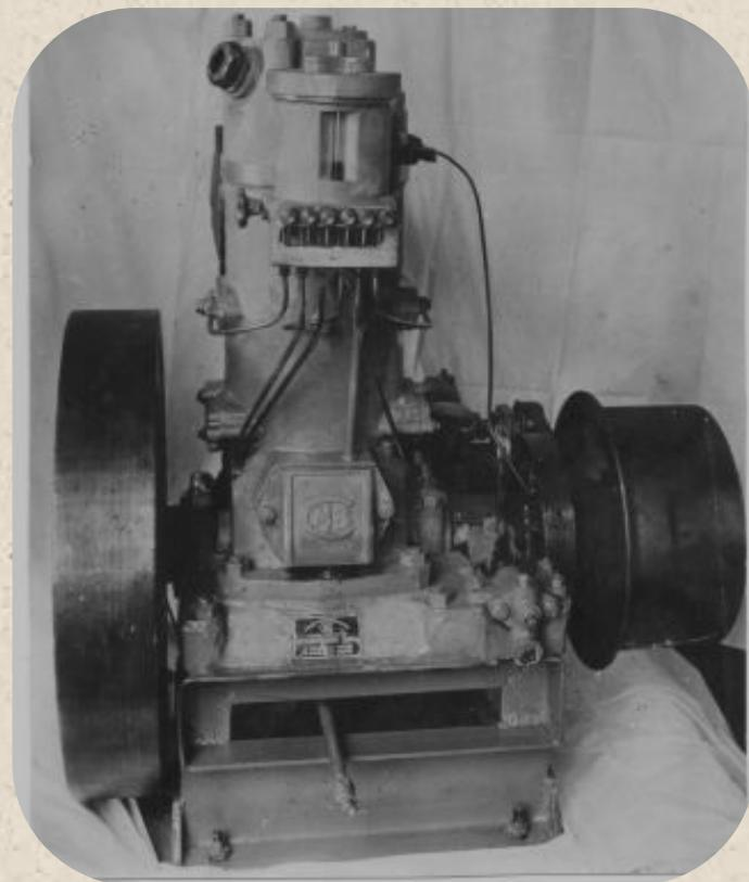
**1946 год.** Выпуск опытного образца одноцилиндрового двухтактного нефтяного двигателя мощностью 15 л. сил 1ПД-18/20.
